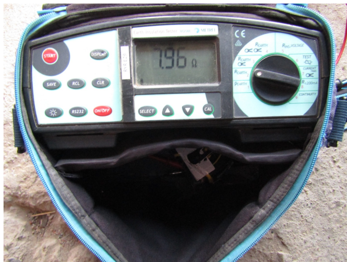
Figura 10.1: Medición de resistencia a tierra.
