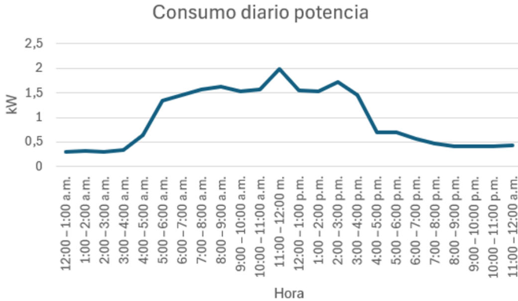
Figura 8.16: Curva de generación diaria típica – Sistema 3.
